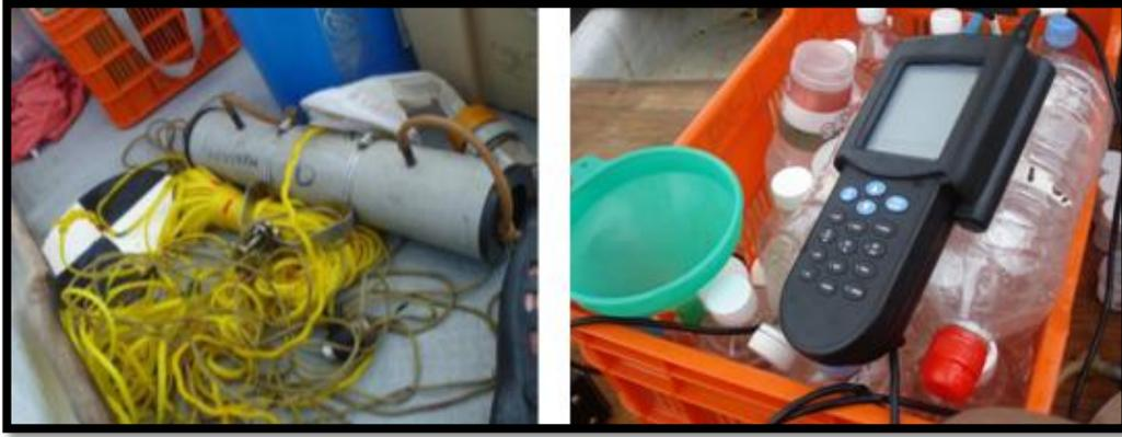
Figura 5. Disco de Secchi, Botella Van Dorn y Potenciómetro.
