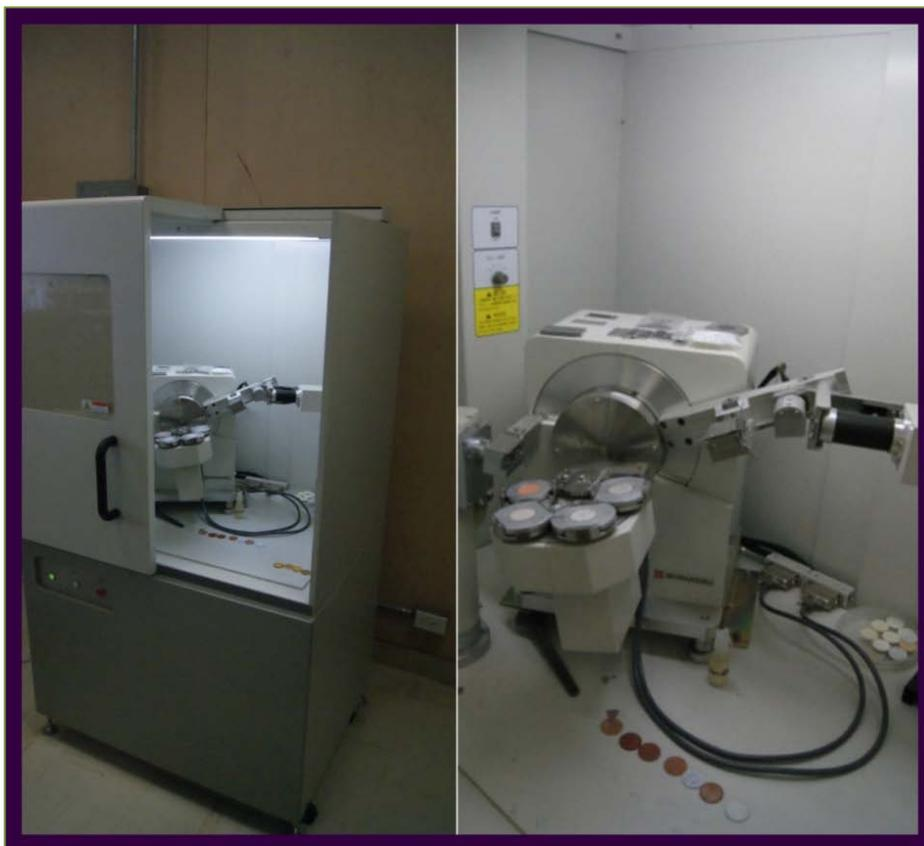
**Figura 3.4.-** La Imagen de la izquierda muestra el Difractómetro de rayos X (DRX) Shimadzu XRD-6000 utilizado para este análisis y la imagen de la derecha se observa el porta muestra automático el cual puede contener hasta para cinco muestras de sedimentos totales.
