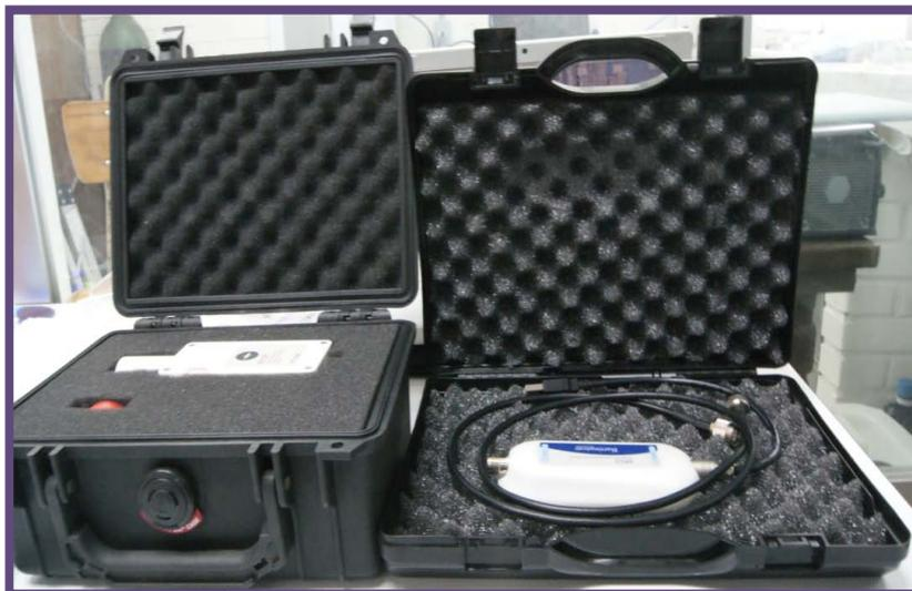
**Figura 3.8.-** El equipo utilizado para medir susceptibilidad magnética (Bartington susceptibility meter y sensor MS2E).
