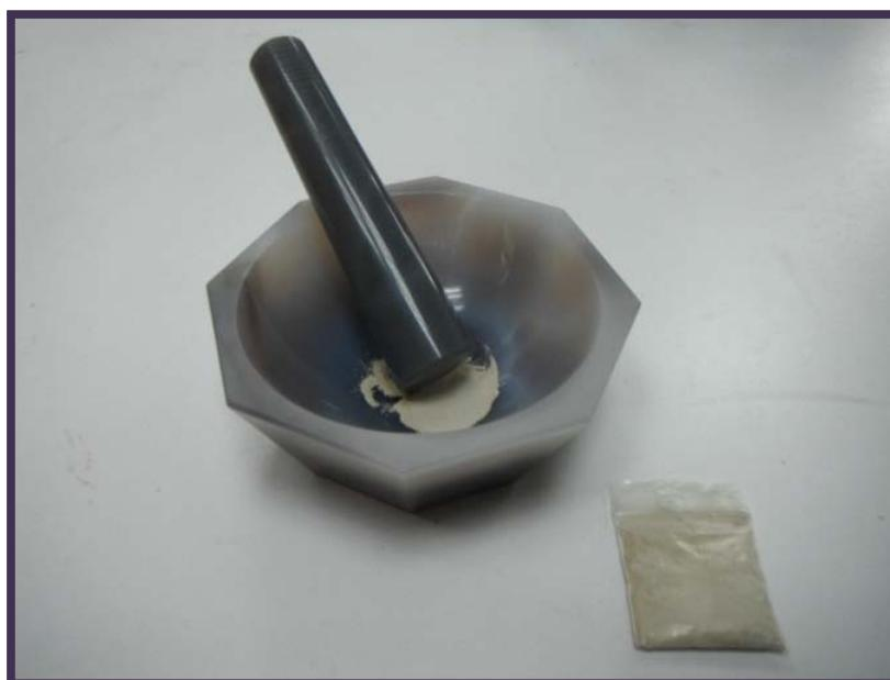
**Figura 3.3-** Imagen donde se observar la muestra molida y homogenizada con el mortero de ágata.
