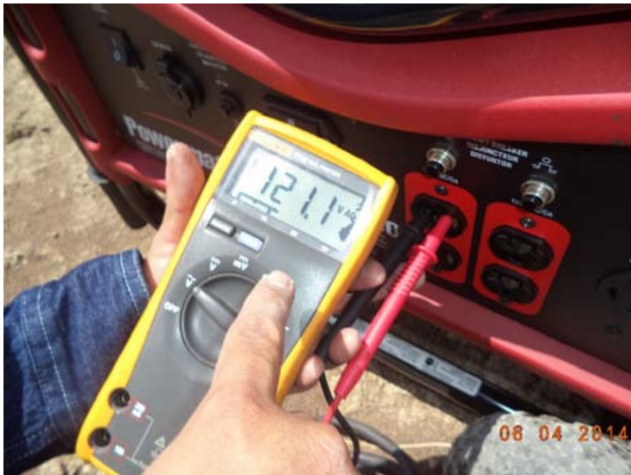
Figura A6. Verificación de corriente a 12 Volts
