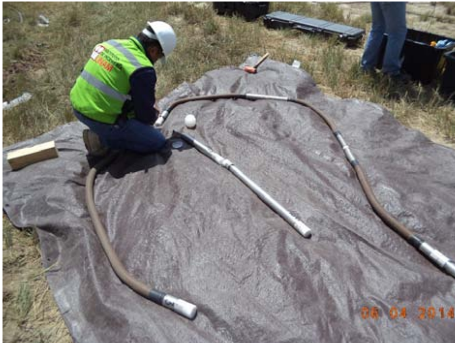
Figura A2. Armado de sonda suspendida
