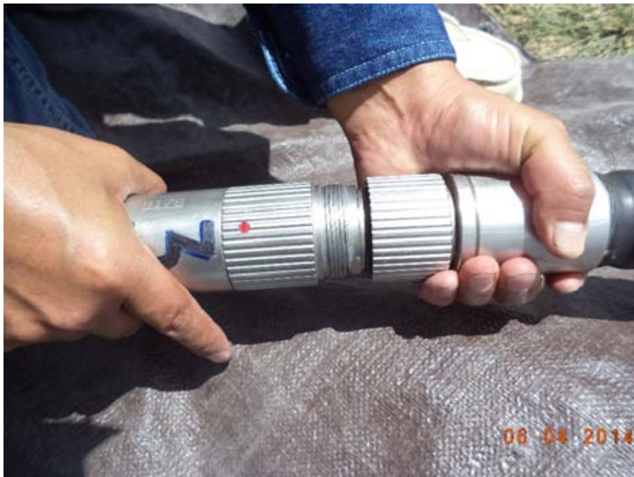
Figura A4. Conexión de sonda suspendida
