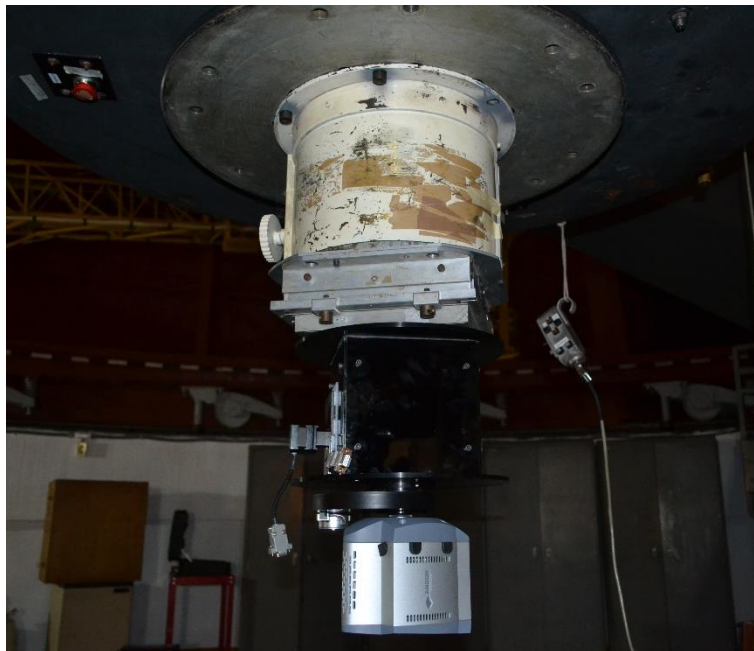
Figura 57 Montaje de la rueda de filtros y de la cámara con CCD.
