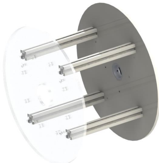
Figura 31 Sustitución de barras por perfiles de aluminio en Berkut
