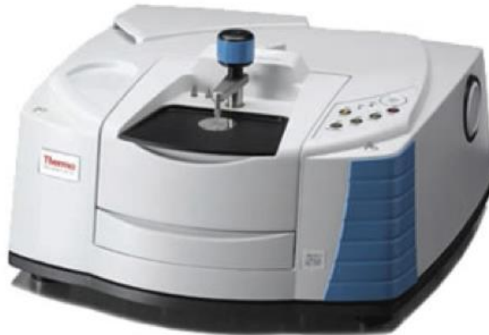
Figura II.5 Espectrómetro de Infrarrojo, marca Thermo Scientific Nicolet iS10 FT-IR, del IGEOL de la UNAM.
