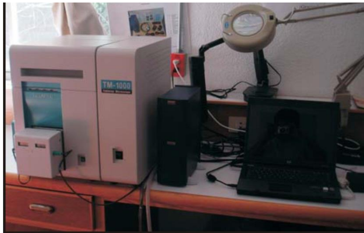
Figura II.6 Microscopio electrónico de barrido portátil TM-1000 del Laboratorio de Petrografía y Minerografía del Departamento de Recursos Naturales del Instituto de Geofísica, UNAM.
