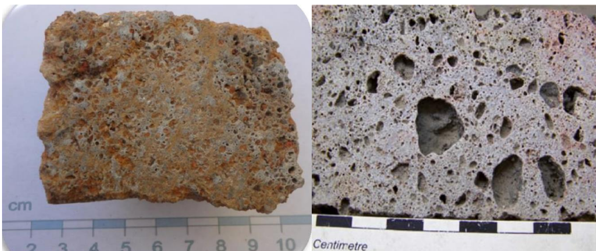
Figura III.9 Alteración vuggy silica en dos yacimientos de alta sulfuración. Derecha, Lagunas Norte, Perú, tomada de Cerpa et al (2013). Izquierda, cuarzo oqueroso y oxidación de La India, México.
