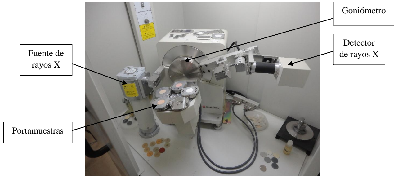
Figura II.4 Difractómetro de rayos X marca Shimadzu XRD-6000 del laboratorio de Rayos X del instituto de geología de la UNAM.
