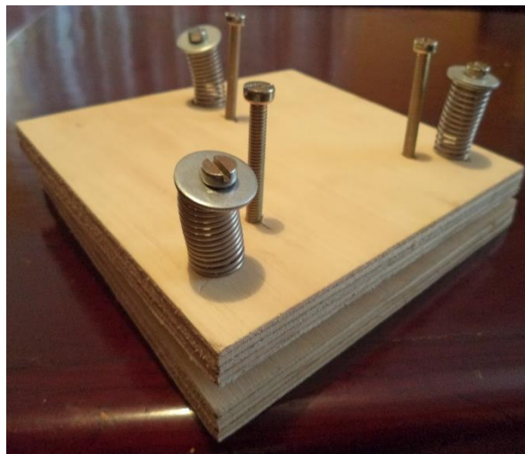
Fig. 3.4. Prototipo de función crítica para el tip-tilt .
