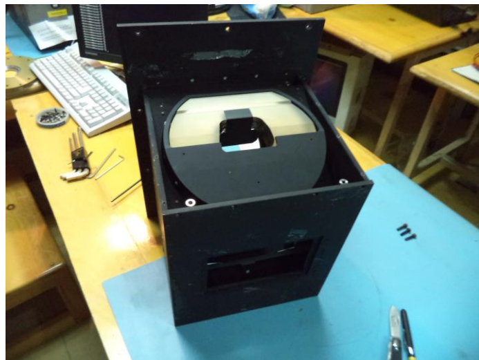
Fig. 5.6. Cámara del espectrógrafo Echelle durante la modificación de sus elementos ópticos.
