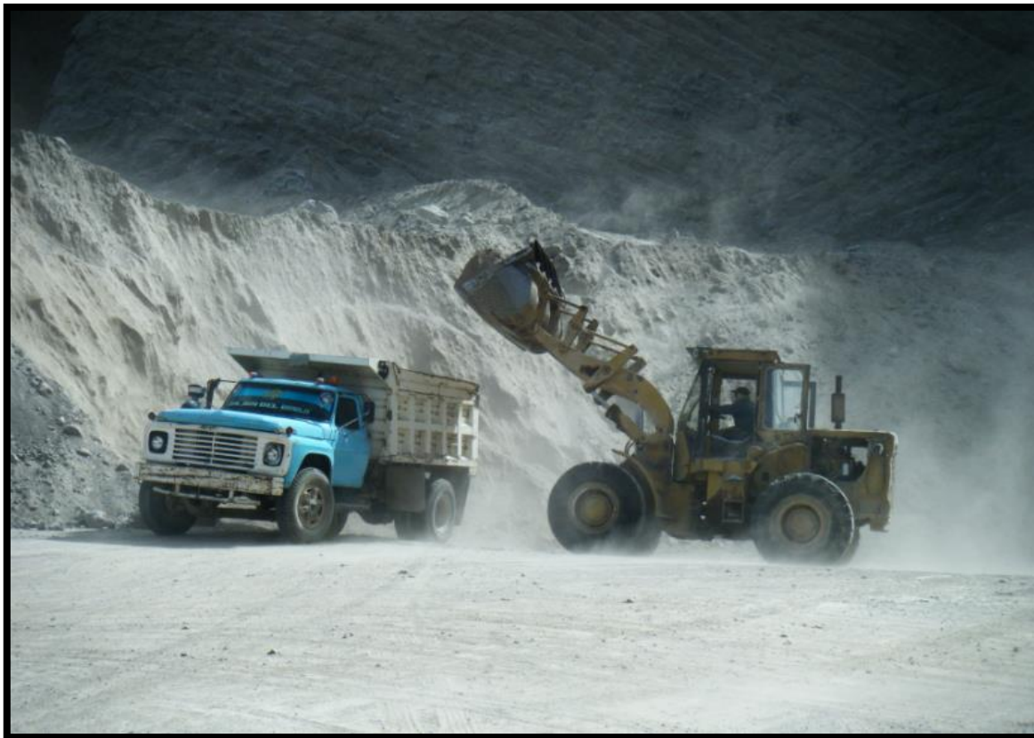
Figura 27. Cargado y acarreo
