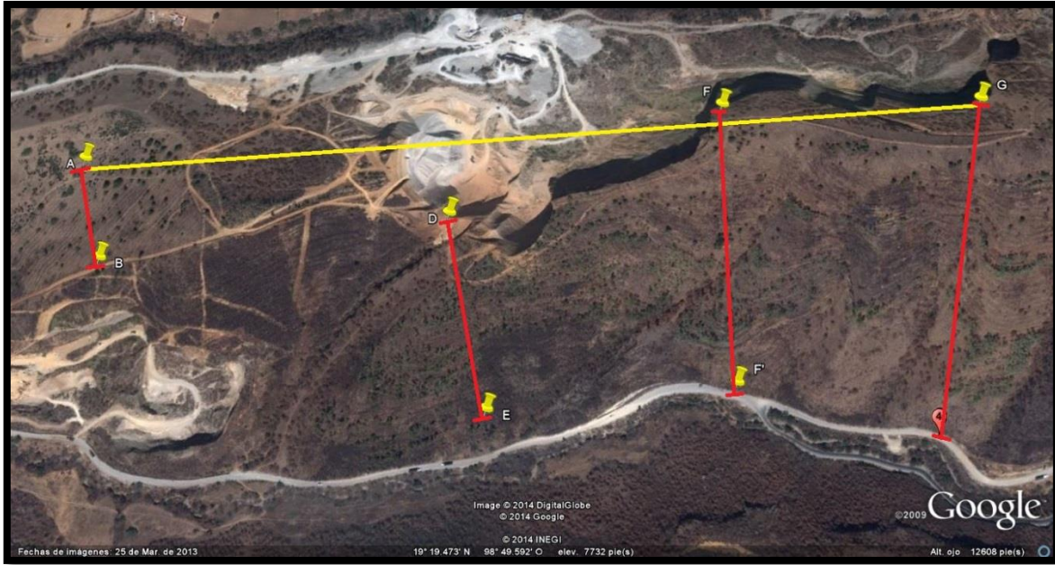
Figura 6. Secciones para el cálculo de reservas
