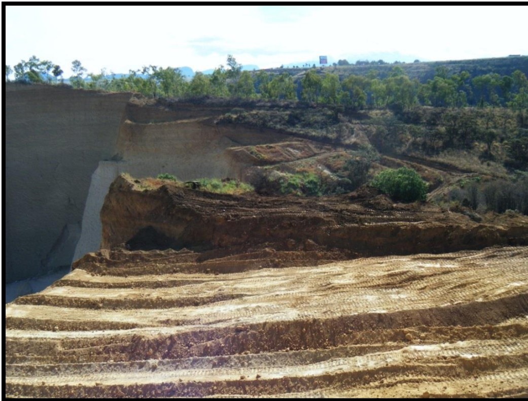
Figura 20. Descapote del banco de producción
