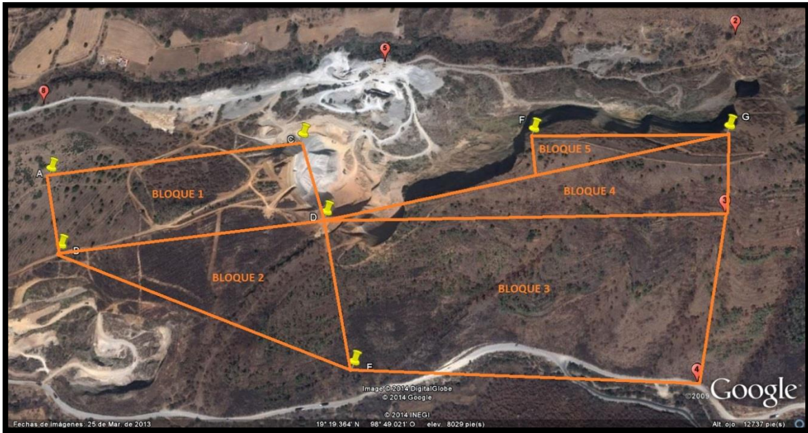
Figura 5. Bloques explotables de la mina El Potrero
