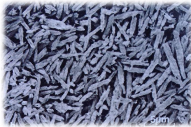
Fig. 11 Disilicato de litio en el SEM 5000x (IPS e.max CAD, Ivoclar Vivadent®). (2)
