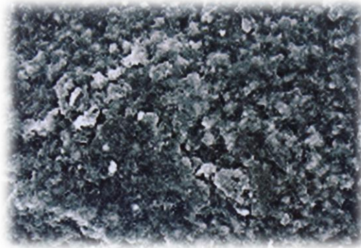
Fig. 2 Vitrocerámica de disilicato de litio con granos de corte pequeño y distribución uniforme (barra 20 \mu , SEM 1000x). (2)
