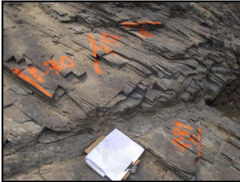
Fotografía 4.25. Se identifican 4 fracturas de diferente orientación para este afloramiento. Nótese la formación de fragmentos tabulares por la intersección de fracturas y foliación.
