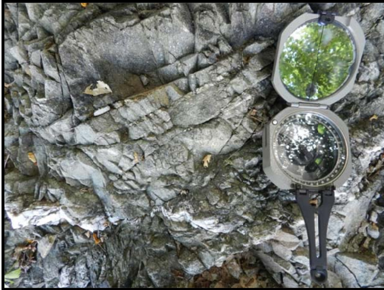
Fotografía 4.5. El intemperismo avanzado en la metaarenisca permite que se disgregue con facilidad a través de los planos de fractura. Nótese la textura granoblástica de la roca.
