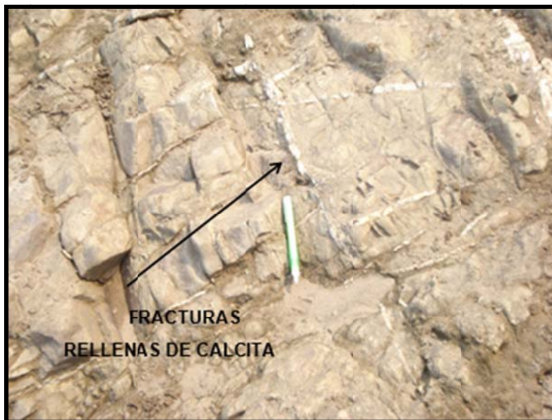
Fotografía 4.26. Fracturas con relleno de calcita que afectan la metaarenisca. Nótese los fragmentos prismáticos formados por la intersección de las fracturas.
