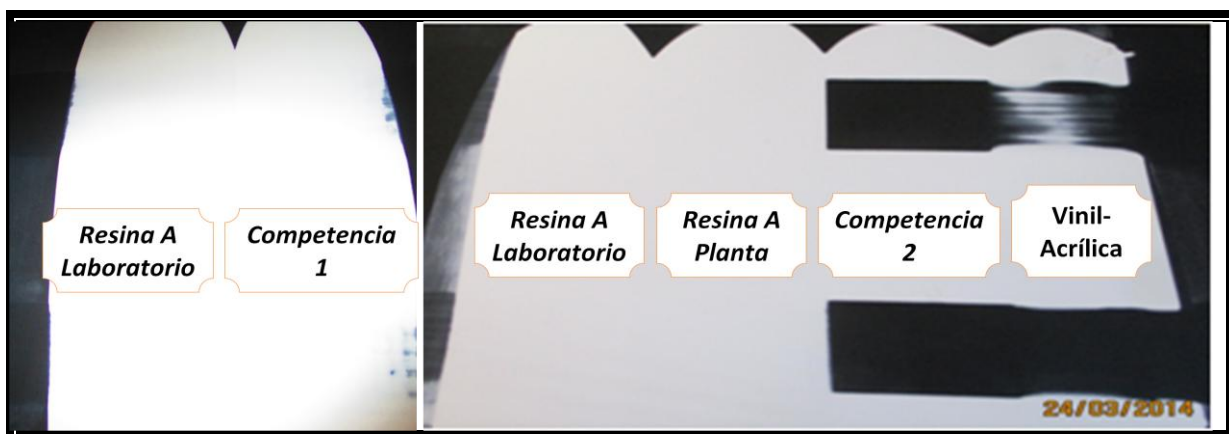
Figura 18. Desempeño en lavabilidad de resinas como pintura a 57 PVC (Resina A Laboratorio y Planta, Competencia 2 y Vinil Acrílica).
