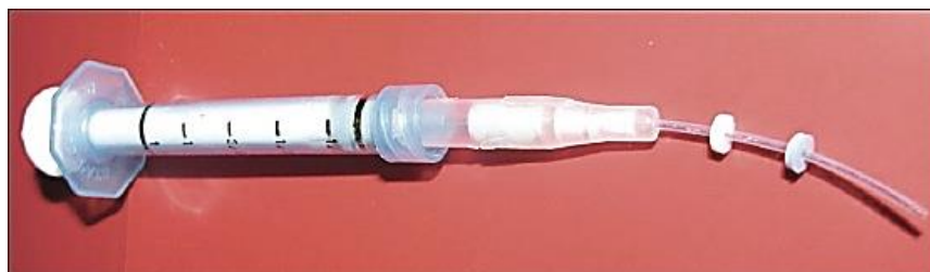
Fig.20 Jeringa diseñada para la inyección de hidrogeles en conductos radiculares 45
