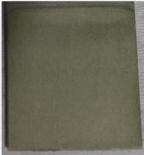
Figura 6.36. Imagen de la placa anodizada con inhibidor  $\text{Na}_3\text{PO}_4$
