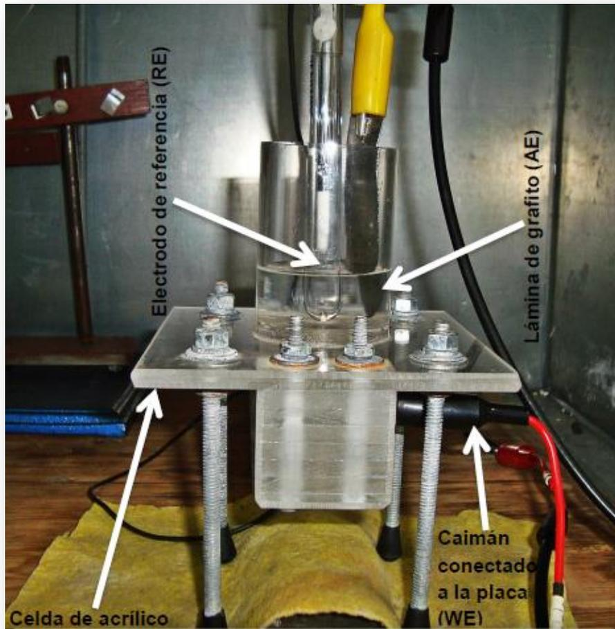
Figura 5.32. Imagen en donde se llevaron a cabo las pruebas de EIS.
