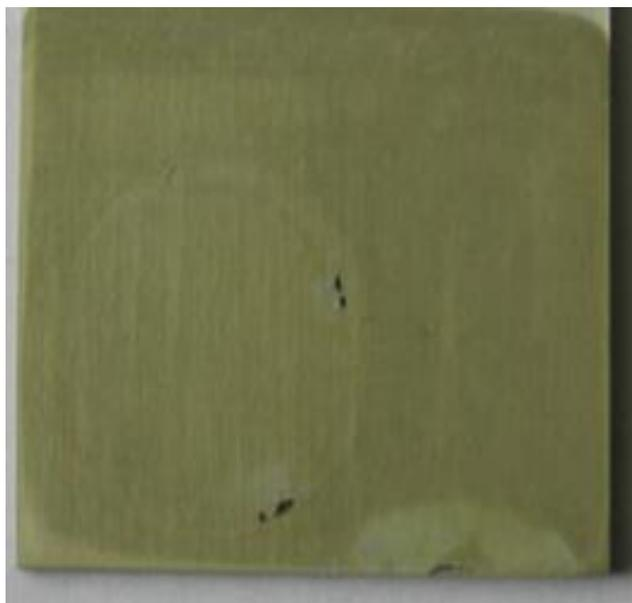
Figura 6.40. Imagen del sustrato recubierto con sol-gel previamente anodizado con inhibidor  $\text{Na}_3\text{PO}_4$
