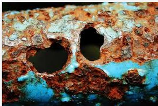
Figura 2.6. Corrosión por picaduras
