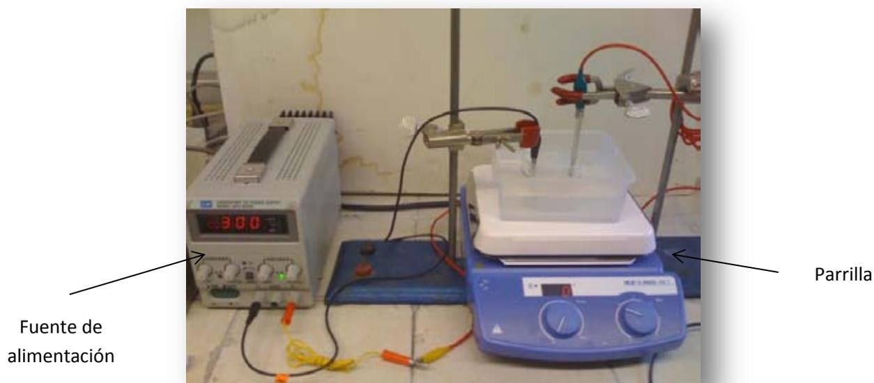
**Figura 5.26.** Proceso donde se llevó a cabo la electrólisis que está constituido por: una fuente de alimentación con dos electrodos, parrilla, vaso de precipitados y dos soportes para sostener los electrodos. La fuente de alimentación regula la intensidad de corriente, la parrilla es para mantener agitación constante con un agitador magnético y el baño de agua es para mantener la temperatura.
