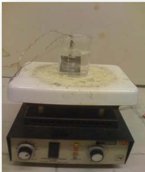
**Figura 5.29.** El sellado de sustrato anodizado se llevó a cabo en un vaso de precipitados lleno de agua sobre una parrilla que suministraba la energía para hacer hervir el agua.
