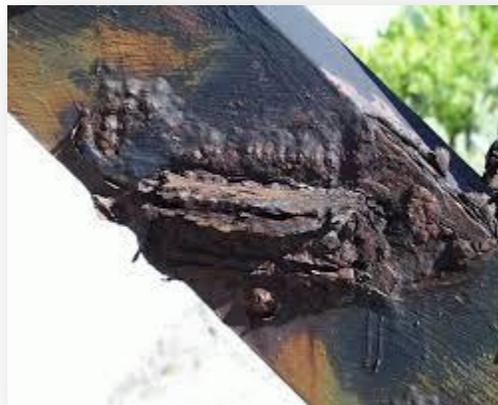
**Figura 2.7. Corrosión intergranular**
