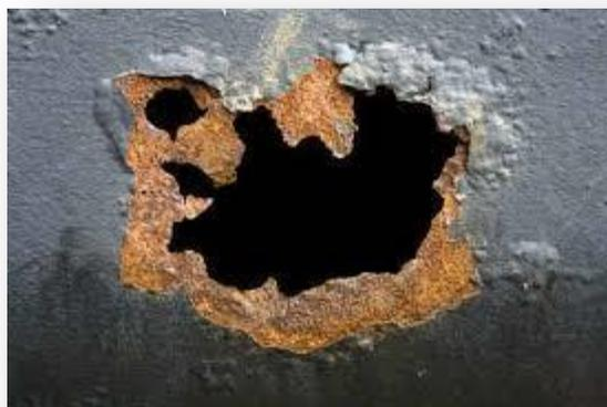
**Figura 2. 1. Daño provocado por la corrosión**
