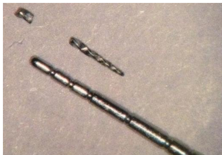
Fig.20. lima de NiTi fracturada como resultado típico de la aplicación de energía ultrasónica al níquel-titanio 10 .
