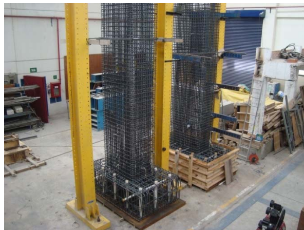
Figura 4.2. Armado del acero de refuerzo del cuerpo de la pila de los especímenes
