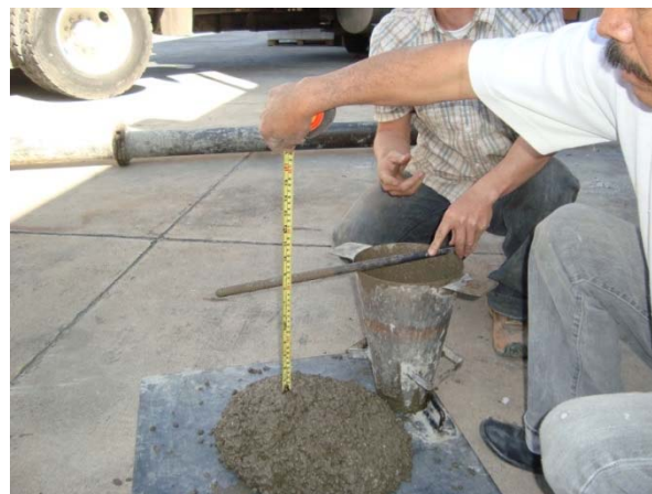
Figura 4.9. Prueba de revenimiento
