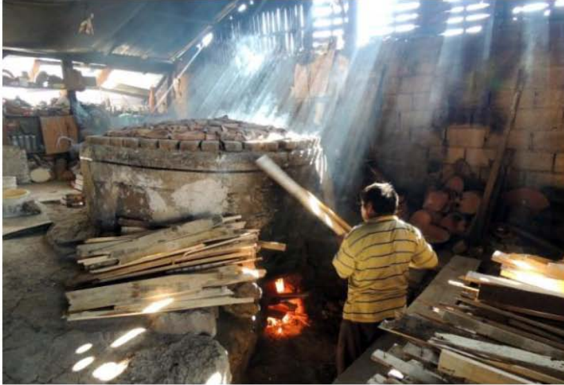
Ilustración 53. Horno de leña con hogar subterráneo. Taller Familiar de Pedro Arroyo, Capula
