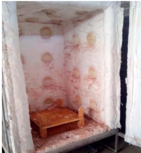
Ilustración 54. Horno de gas, estructura de fierro. Taller Ma. Inés Leal, Capula
