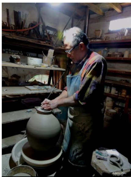
Ilustración 46. Torneado sin tarraja. Cooperativa de Alfareros de Patamban. Alfarero Ricardo Calderón, Patamban
