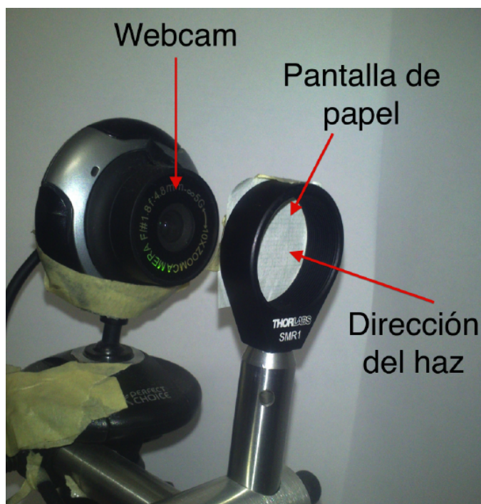
Figura 2.3: Equipo para la medición del perfil de intensidad del haz. Se utilizó una cámara web comercial (PerfectChoice) para la captura de las imágenes necesarias para realizar el análisis; esta se mantuvo montada en un poste con una pantalla de papel milimétrico colocada paralela al sensor de la cámara.
