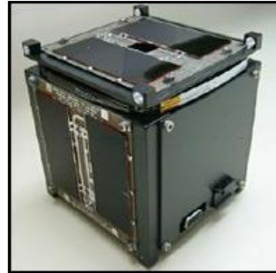
Fig. 126. Ejemplo de CubeSat. Crédito NASA.
