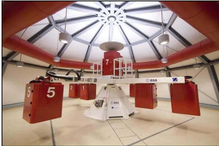
Fig. 132. Centrifugadora LDC de la ESA. Crédito: ESA.
