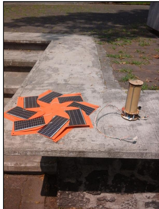
Fig. 109. Prueba de transmisión de la carga útil con los paneles solares
