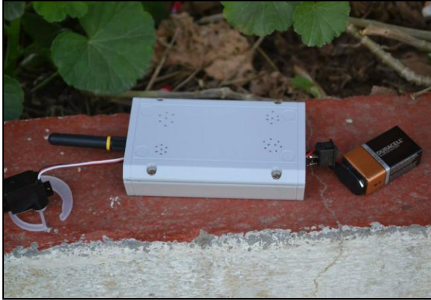
Fig. 58. Sistema liberador de CanSats, a la izquierda de la foto se observa el mecanismo en el servomotor.
