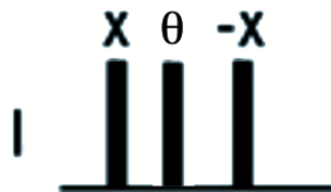
Figura 2.23: Representación gráfica de la secuencia de pulsos para implementar un cambio de fase por un ángulo \theta . Para el núcleo I , se aplica primero un pulso de 90^\circ en la fase x , después un pulso de \theta grados en la fase y y finalmente otro pulso de 90^\circ en la fase -x . En RMN la aplicación de los pulsos se da de izquierda a derecha mientras que la aplicación de los pulsos de forma matemática se hace de derecha a izquierda.
