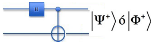
Figura 2.37: Figura que representa a la generación de estados de Bell dentro de un circuito.
