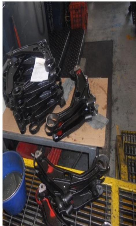
El proceso requiere que el maquinado realizado a las piezas sea de pieza terminada lista para ensamble. Por esta razón, se requiere una alta precisión dimensional en las operaciones, además de un excelente acabado superficial.
