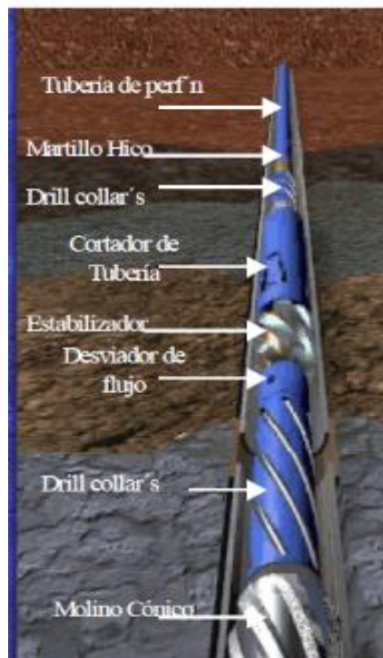
Figura 5.15 Diseño de sarta típica para una apertura de ventana.
