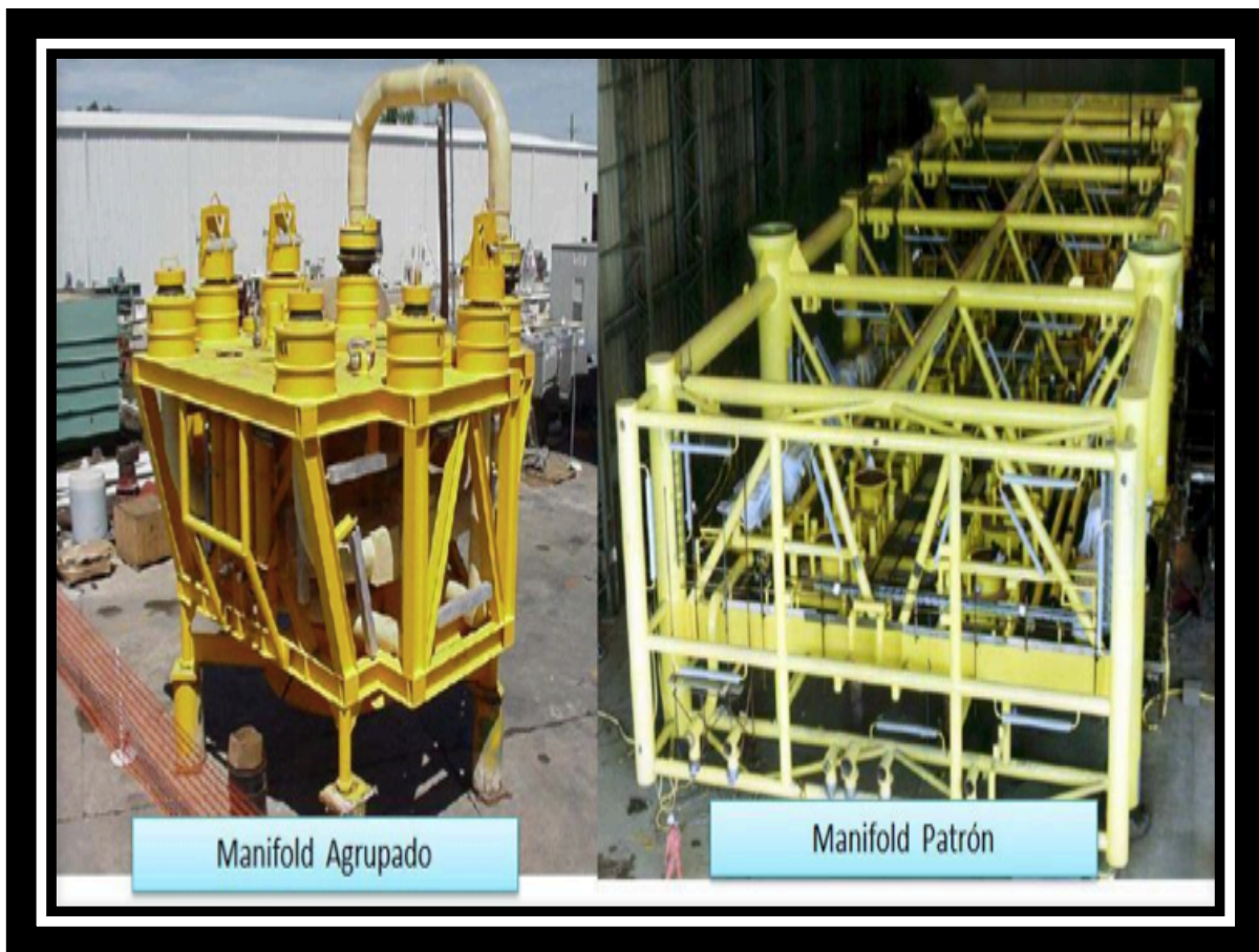
Figura 1.19. Tipos de manifold. (Lindsey-Curran, 2004).
