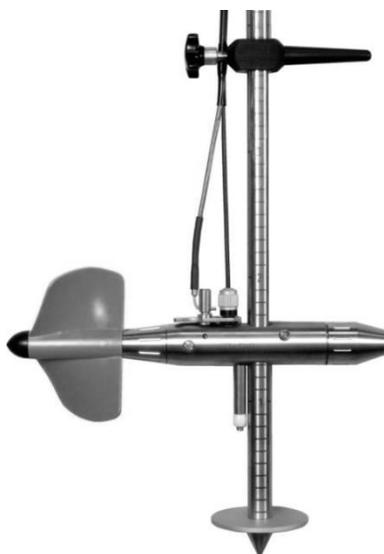
Fig. No.1.7 Corrientómetro
