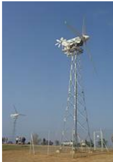
Ilustración 8. Aerogenerador de 1984 capaz de producir 24 KW
