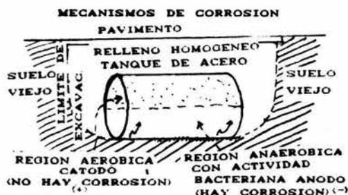
Figura 4.18. Actividad Bacteriana. La actividad metabólica de ciertos microorganismos puede crear ambientes corrosivos alrededor de una estructura subterránea
