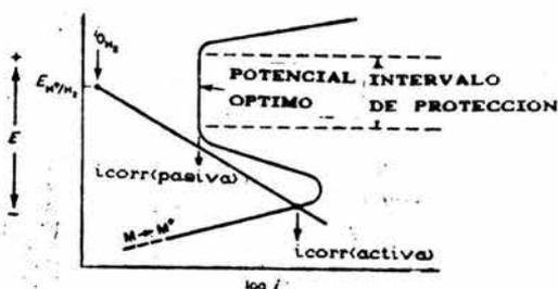
Figura 5.15. Diagrama esquemático que muestra el rango de protección y el potencial óptimo para la protección anódica de un metal activo-pasivado.
