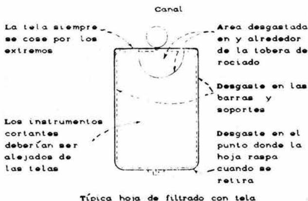
Figura 4. D. El desgaste de la tela filtrante ocurre en estas áreas
