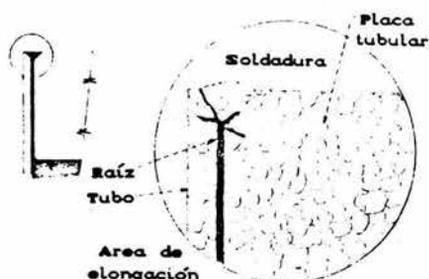
Figura 4.10. Rasgaduras propagándose en la soldadura, tubo y placa tubular
