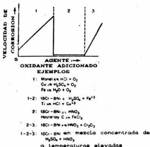
Figura 2.13. Efectos de los agentes oxidantes y la aeración sobre la velocidad de corrosión.
