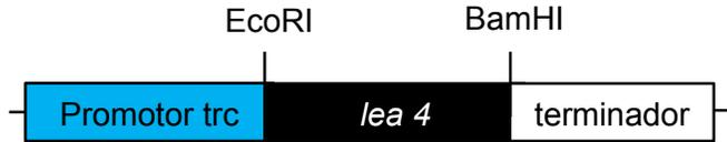
**Figura 16.** Esquema general de la construcción pTrc99a-*lea 4*. El marco abierto de lectura que codifica para LEA 4 se clonó entre los sitios EcoRI en el flanco 5' y BamHI en el 3' y bajo el promotor trc, el cual es inducible por IPTG.
