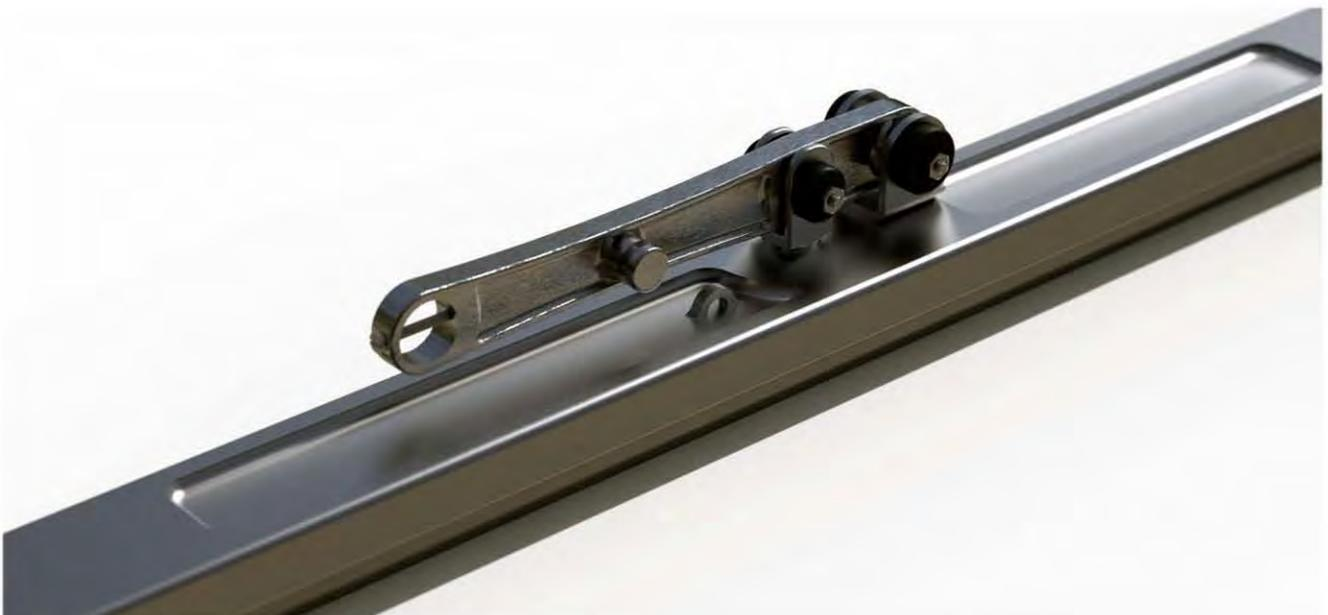
Fig. 76. Render del lado interno del mecanismo del riel. Se muestra la ubicación del resorte. (Elaboración propia)
