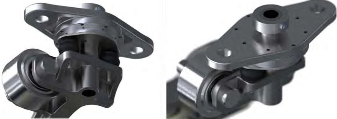
Fig. 110. Se muestra la compresión del bogie. En la parte superior existe un collarín que limita el movimiento y en la parte inferior los orificios en el soporte principal que funcionan como guía. (Elaboración propia)
