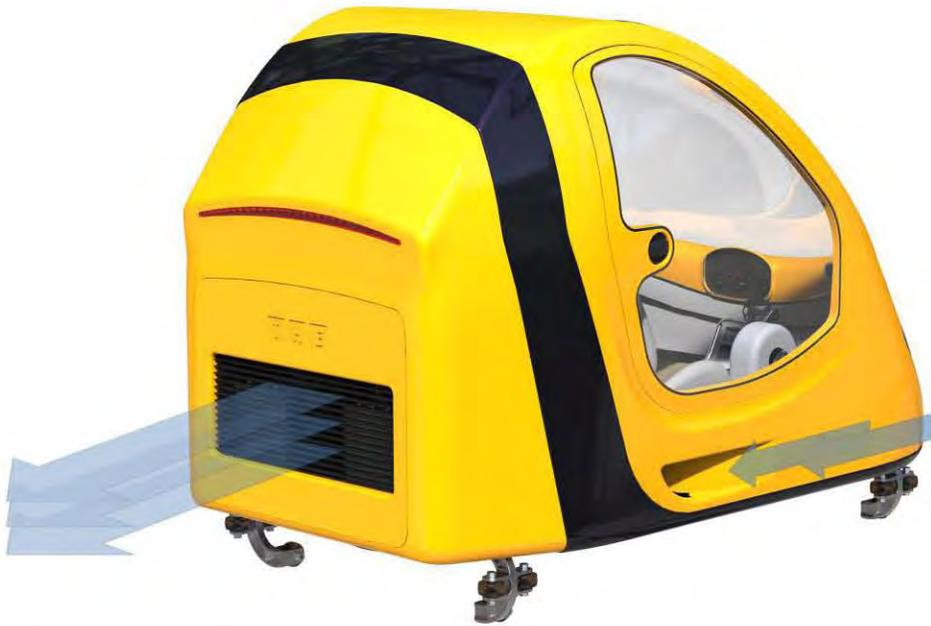
Fig. 181. Ventilación de los componentes electrónicos. Entradas de aire laterales y salida de aire en la parte posterior. (Elaboración propia)
