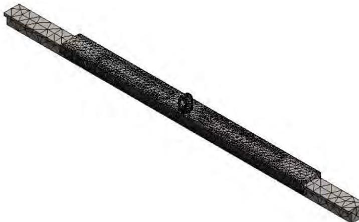
Fig. 85. Mallado del riel de desplazamiento (AEF). (Elaboración propia)
