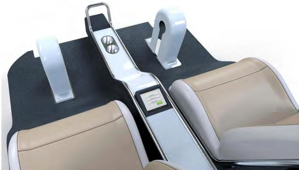
Fig. 100. Render de la consola central mostrando la pantalla de control del vehículo. (Elaboración propia)
