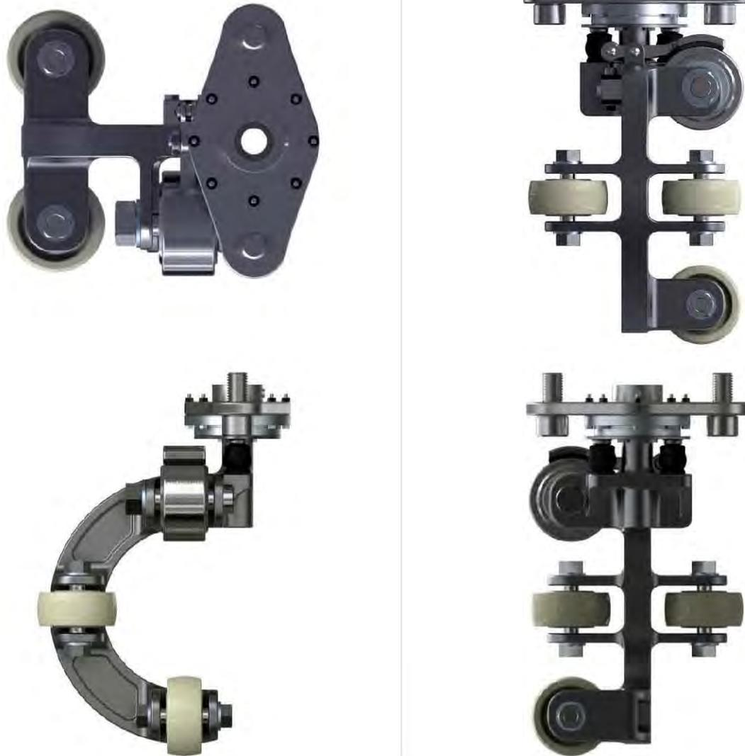
Fig. 123. Varias vistas del ensamble completo del bogie. (Elaboración propia)
