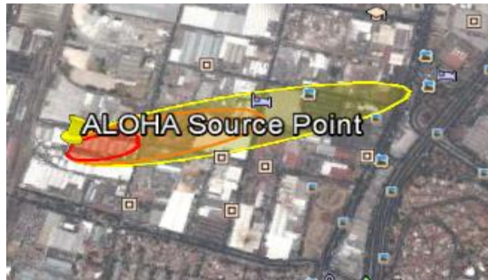
Diagrama 16: Zonas de riesgo por la dispersión de cloro vista desde Google Earth
