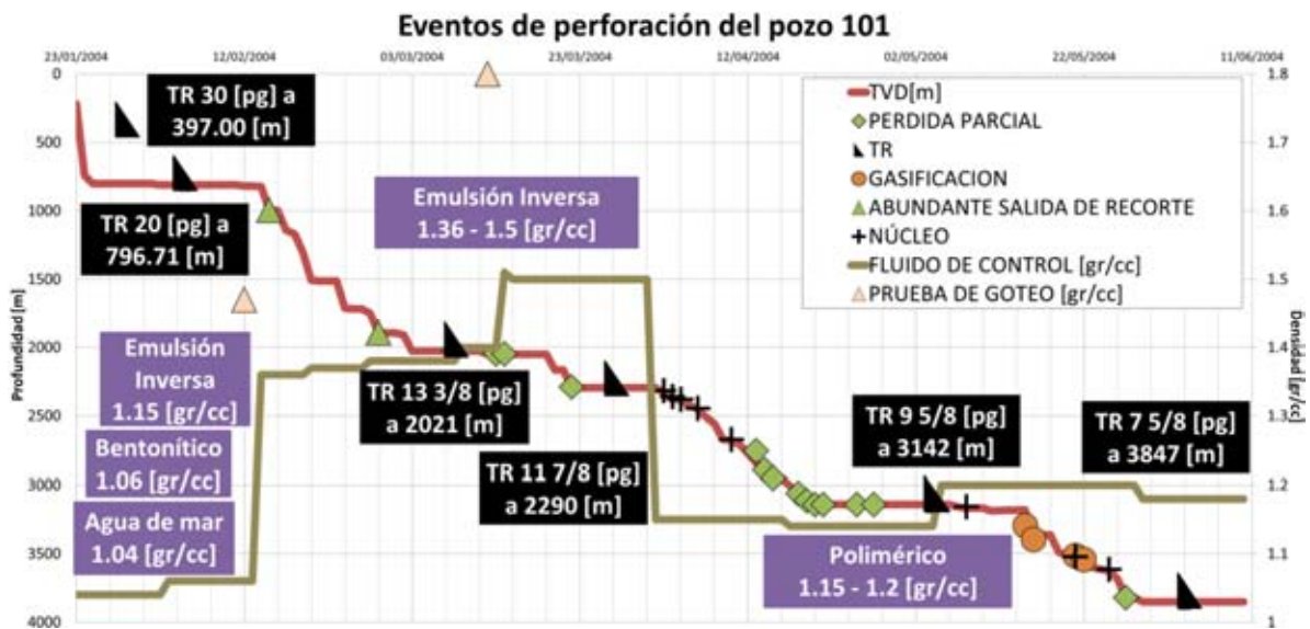
Figura 5. 6 Eventos de perforación del pozo 101.
