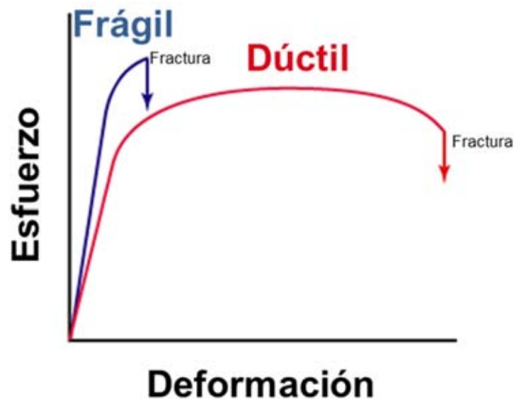
Figura 4. 1 Comportamientos frágil y dúctil en términos de esfuerzo contra deformación.
