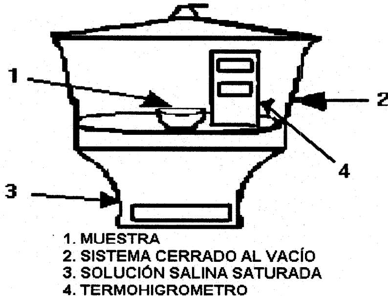
Figura 4.1. Sistema para generar las diferentes humedades relativas a evaluar.
