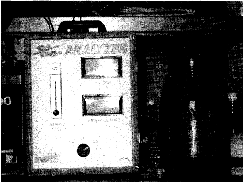
Figura 5.3. Determinación de la velocidad de respiración ( R_x ) por sistema cerrado.
