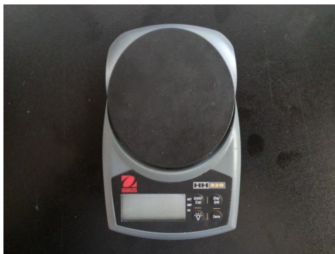
Figura 3.15 Balanza portátil para medir pérdida de masa de las muestras de mango durante el proceso de secado solar.
