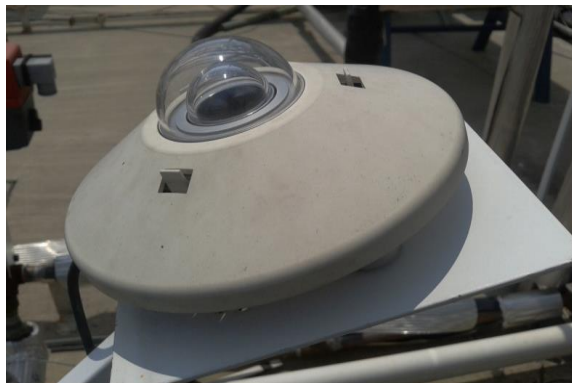
Figura 2.20 Piranómetro marca Kipp & Zonen empleado para medir la radiación solar.
