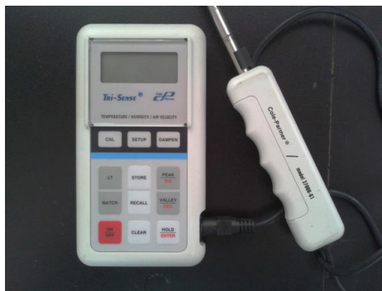
Figura 2.17 Anemómetro de hilo caliente para determinar la velocidad del viento a la entrada del captador.
