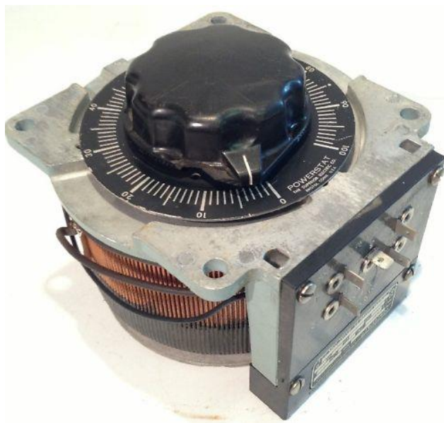
Figura 2.7 Autotransformador Powerstat modelo 136BU utilizado como regulador de voltaje para controlar la velocidad de giro del ventilador inyector de aire.
