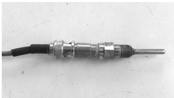
Figura 2.13 Sensor PT-100 (Termistor) para la medición de la temperatura ambiente.
