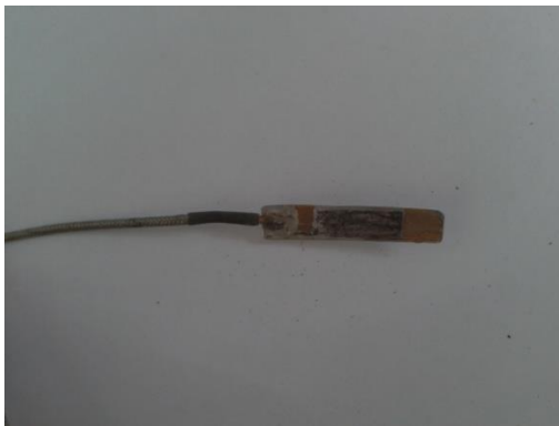
Figura 2.12 Termopar de superficie tipo J para determinar las temperaturas de la placa absorbadora, cubierta transparente y parte posterior del captador.
