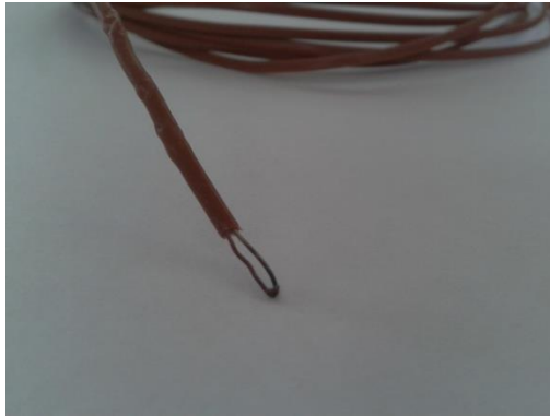
Figura 2.11 Termopar tipo T para determinar las temperaturas de entrada y salida del aire del captador.
