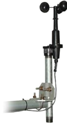
Figura 2.19 Anemómetro modelo es el 03101.
