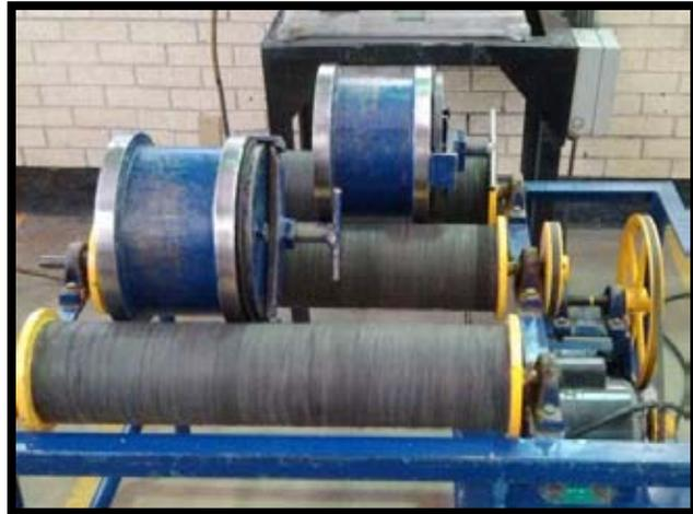
Figura 2.2.5. Molino de bolas de laboratorio.
