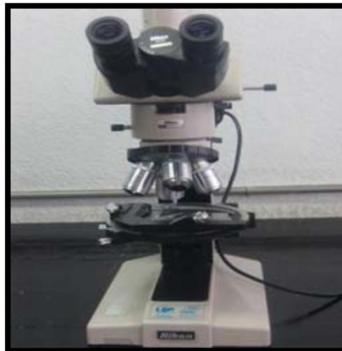
Figura 2.3.1. Microscopio menagráfico NIKON OPTIPHOT.
