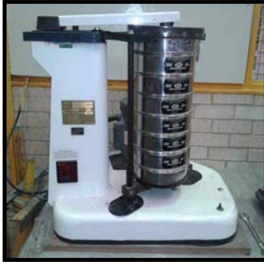
Figura 2.2.3. Dispositivo para clasificación por cribado “Ro-Tap” y selección de cribas.
