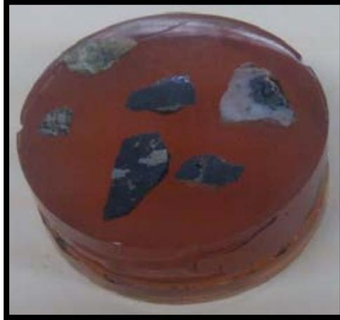
Figura 2.3.2. Probeta del material para analizar mediante la técnica de menagrafía, montada en resina epóxica.
