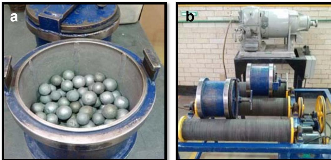
Figura 2.2.2. a) Superficie interior de un molino de bolas de laboratorio, b) Molino de bolas (vista exterior) y proceso de molienda.
