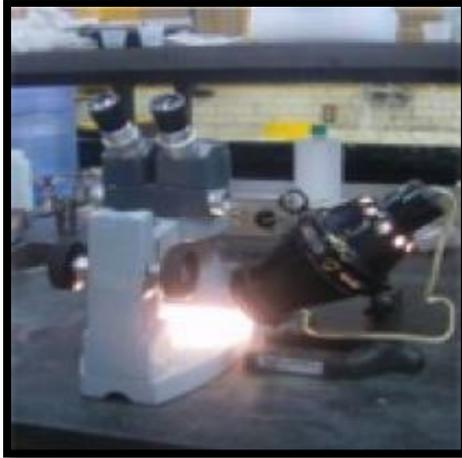
Figura 2.2.4. Microscopio American Optical para determinar tamaño de liberación.
