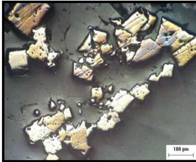
Figura 3.1.1. Menografía que muestra un mineral de Pirita. Capturada con las siguientes condiciones: Campo Claro, Nicoles Paralelos y Sin Polarizador; Tomada a 100X.
