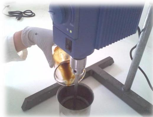
Imagen 2. Agitación empleando el agitador mecánico
