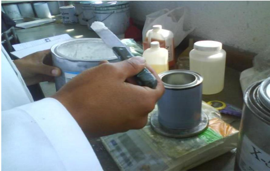
Figura 6.- Se pesó de manera exacta en una balanza granataria y se agregó el dióxido de titanio a cada una de las muestras, antes de agregar el endurecedor (resina).
