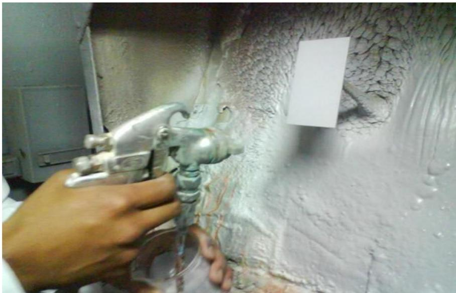
Figura 9.- Pintado de cada una de las placas y probetas con su respectiva formulación.
