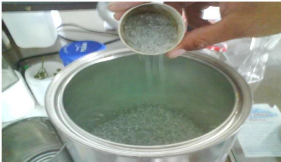
Figura 7.- Antes de ser cerradas cada una de las latas con las diferentes formulaciones se agregaron 25 gramos de perlas de vidrio a cada una para ser llevadas al molino.
