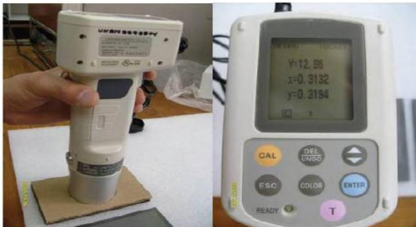
Figura 10.- Colorímetro Minolta
