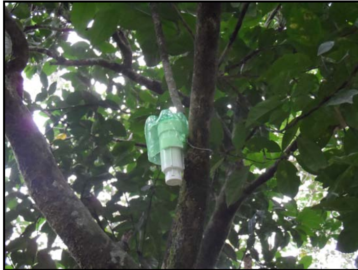
Fig. 14. Sensor de temperatura y humedad relativa instalado en la localidad Tuzamapan
