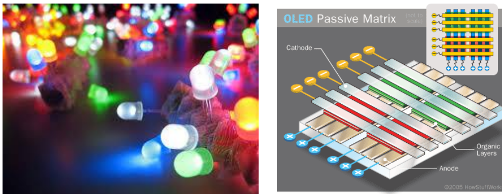
Figura 5. (izq) Focos de LEDs; (der) Dispositivo OLED para uso en pantallas.
