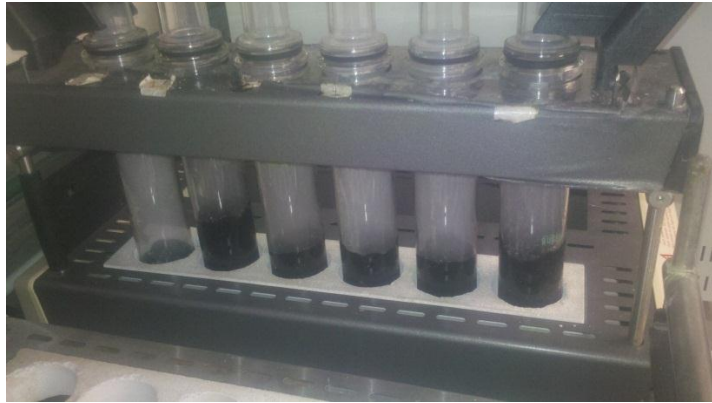
Fig 11. Equipo digestor con extracción de humos.
