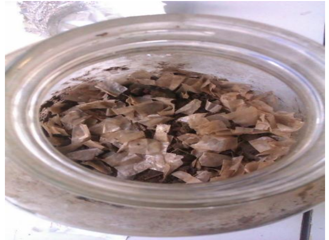
Fig. 16 Reactor aerobio en el proceso de compostaje con PeTO
