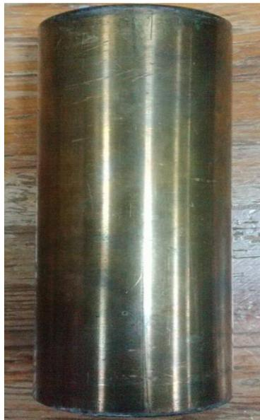
Figura 4-5. Probeta de bronce usada en las inspecciones.
