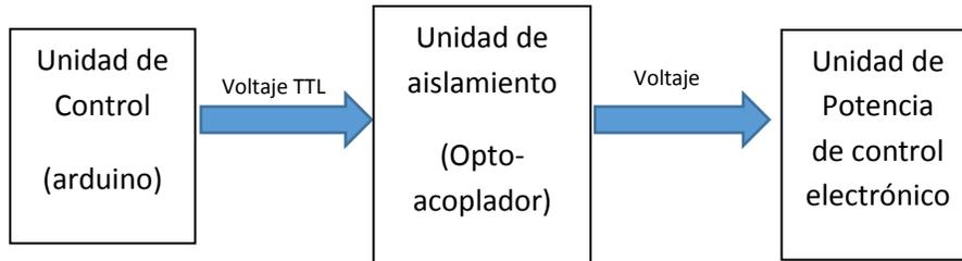
Figura 3-2. Esquema de la unidad de aislamiento
