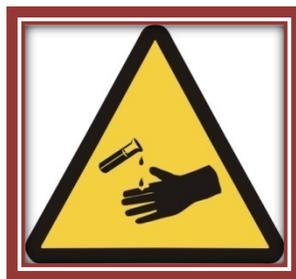
Figura 1. Pictograma de “Precaución, sustancias corrosivas” (NOM-026-STPS-2008 - Colores y señales de seguridad e higiene, e identificación de riesgos por fluidos conducidos en tuberías, 2008).
