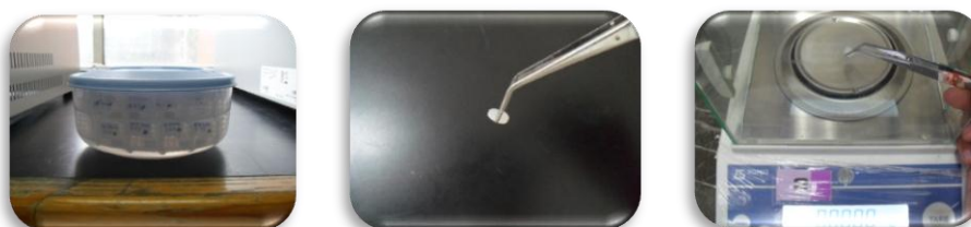
Fig. 38) Muestras en agua desionizada. Fig. 39) Secado de las muestras. Fig. 40) Segundo peso de cada muestra.
