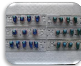
Fig. 67) Colocación en resina acrílica.
