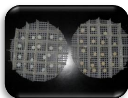
Fig. 33 Muestras para prueba de sorción y solubilidad.
