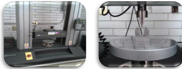
Fig. 22 y 23 Colocación de las muestras en la maquina INSTRON.
