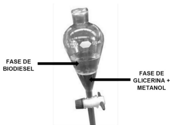
**Figura 4.5.** Fases presentes durante la separación de biodiesel.
