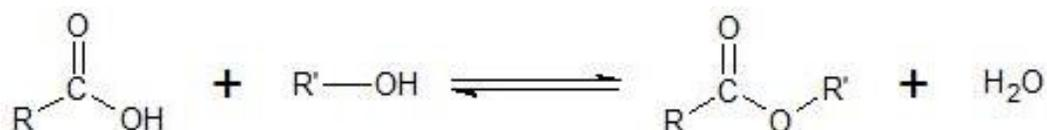
**Figura 2.1.** Esquema general de la reacción de esterificación.
