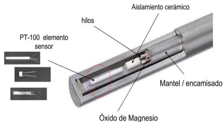
Figura 11. Vista interna de una Termorresistencia. ( www.uhu.es/prochem/wiki )
