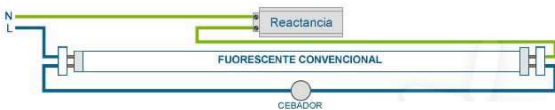
Figura 42 Conexión de tubos fluorescentes [7]
