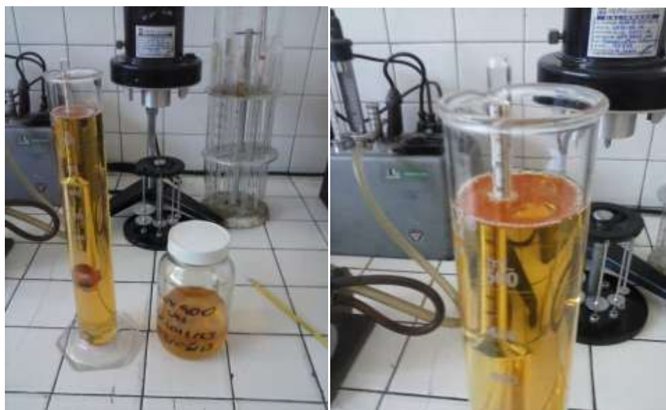
Figura 14.- medición con hidrómetro
