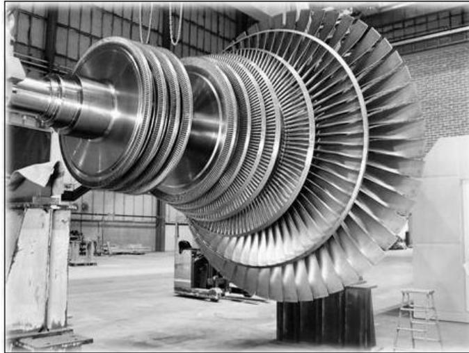
**Figura 2.13 Turbina de vapor (RENOVETEC, 2013)**
