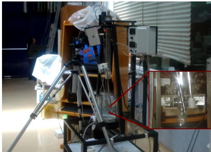
Figura 6.8-1. Montaje del sistema de videoendoscopía en el tanque de mezclado.
