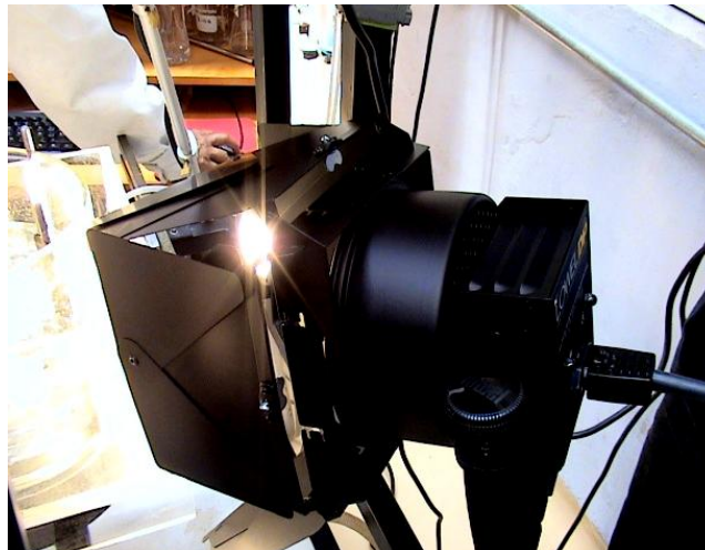
Figura 6.6-2. Iluminación por medio de Spot.
