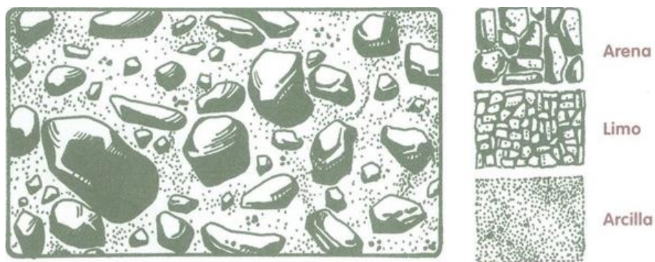
Figura 2.- Esquema del tamaño de las partículas que componen el suelo.
