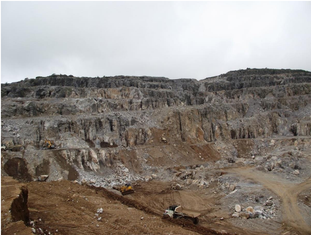
Figura IV- 13 Área 2. Esta área ya presenta una geometría más uniforme, sin embargo no existe una continuidad del área sur con la norte por la obstrucción que ha generado el material estéril, los bancos en ciertas áreas alcanzan los 25 metros.
