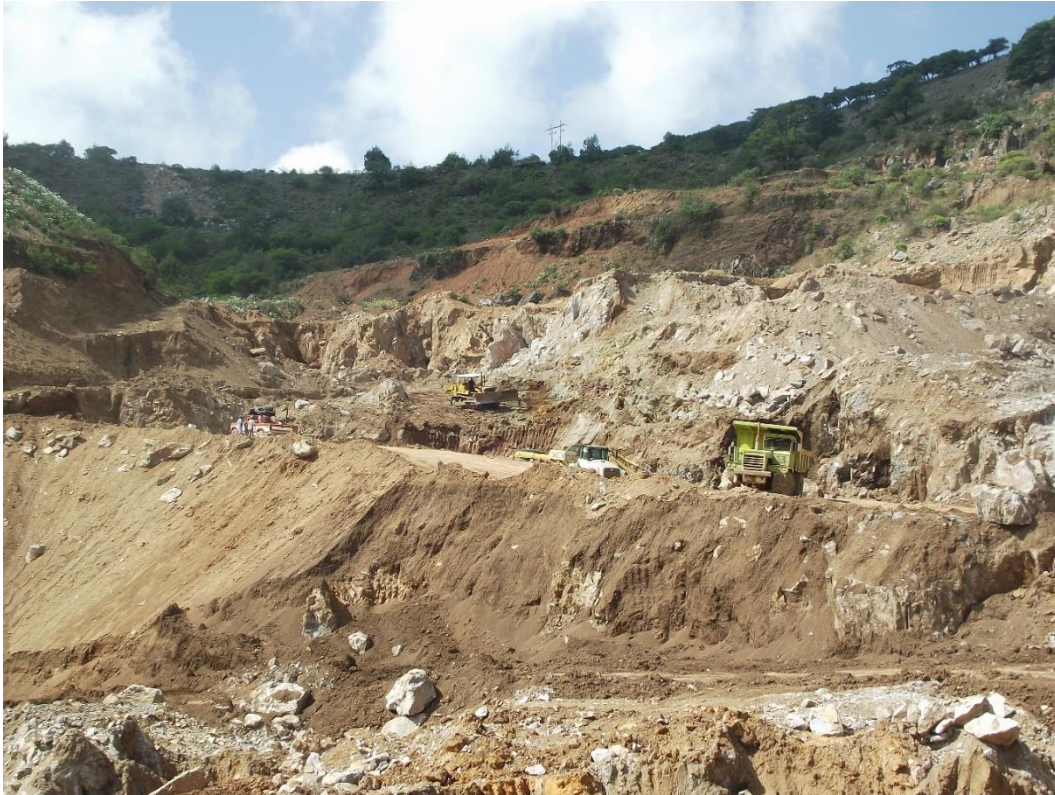
Figura IV- 12 Explotación del área 1. Nuevamente la figura muestra la falta de bancos y la gran cantidad de material estéril que presenta el área.
