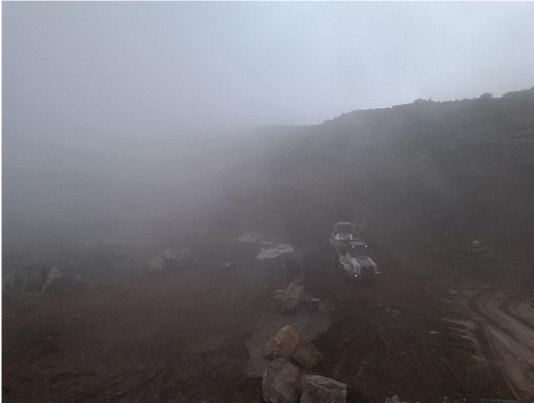
Figura IV- 4 Afectaciones por el clima. La neblina no permite ver más allá de 3 metros, en los caminos de genera encharcamientos.
