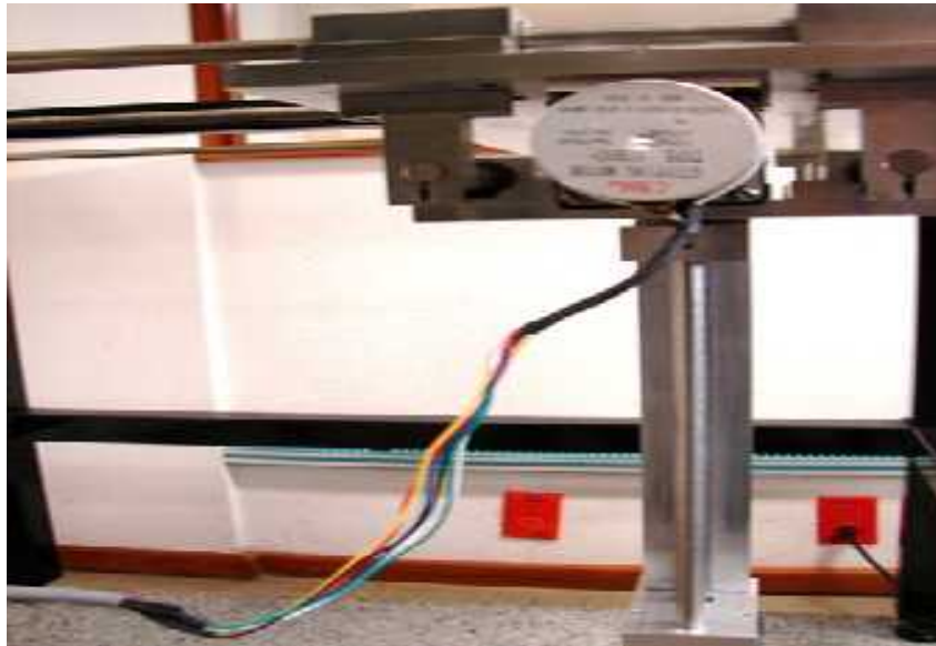
Figura 34. Cables de control de los motores
