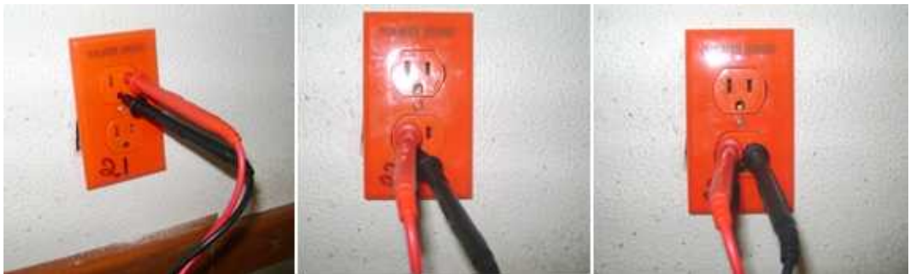
Figura 46. Lecturas de voltajes correspondientes a fase-neutro, fase-tierra y neutro-tierra del contacto
