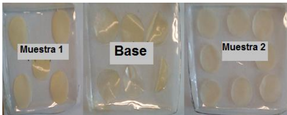
Figura 18. Forma de recortar los parches transdérmicos para medir con Vernier
