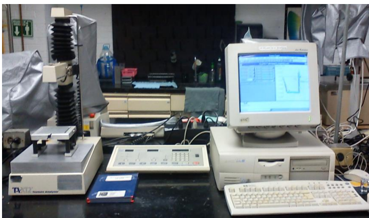
Figura 19. Texturómetro marca Texture Technologies Corp modelo TA-XT2 y parámetros de prueba de bioadhesión
