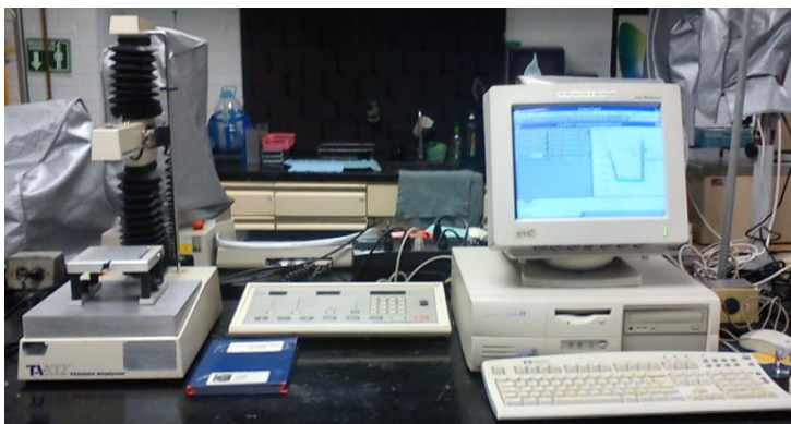
Figura 21. Texturoméetro marca Texture Technologies Corp. modelo TA-XT2 y parámetros de prueba resistencia a la ruptura
