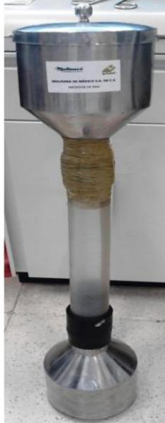
**Figura 21.- Medidor de volumen para pan.**
